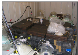
地下測定室に設置され厳重に遮蔽された Ge 検出器
