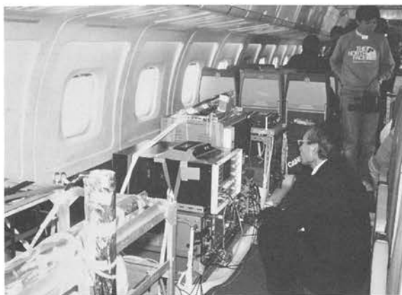
エアーボーンによる宇宙線観測γ線サーベイを行ったさいの機中の状況(日航DC8)(p.3)
