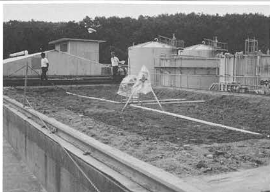
人形峠ウラン鉱野外溶出実験場での In-Situ測定 (p. 3)
