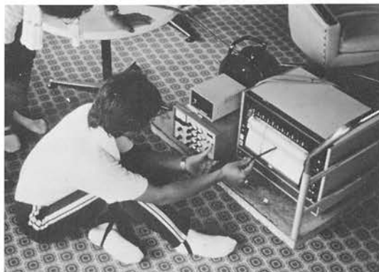
可搬型4チャンネルサーベーターによる測定 (p. 4) (岡山大温研・飲泉場)
