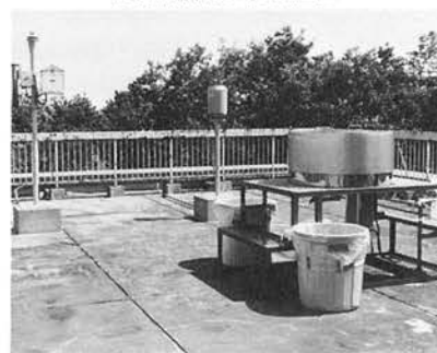
降下ばいじん・降水採取器 日照計・温湿度計・雨量計
