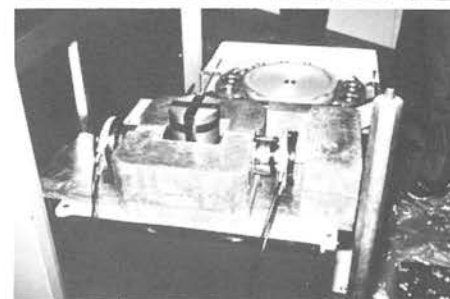
低バックグラウンド液体シンチレーション 測定装置：外観と内部検出器部分
