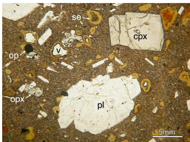
図2 岩石試料の偏光顕微鏡写真 (下方ポーラーのみ)。se, 二次的鉱物 (緑泥石や粘土鉱物); v, 孔隙。ほかの略字は表1のものと同じである。
