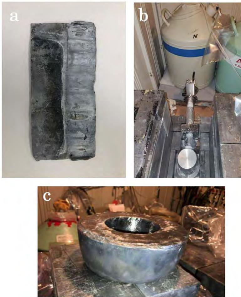
図3 a) 金沢城鉛瓦に使用された鉛板, b) Ge検出部ヘッドおよびc) ヘッド形状に合わせ鑄形された鉛の遮蔽材.
