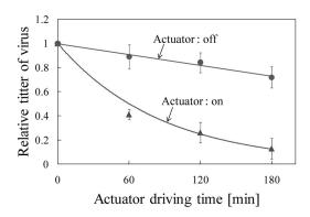
Fig. 7 キャビテーション発生装置の連続駆動によるウイルス不活性化の評価結果
