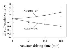
Fig. 8 キャビテーション発生装置の連続駆動による大腸菌殺菌の評価結果
