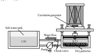
Fig. 3 水循環機構を持つキャビテーション発生装置
