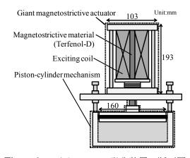
Fig. 1 キャビテーション発生装置の断面図
