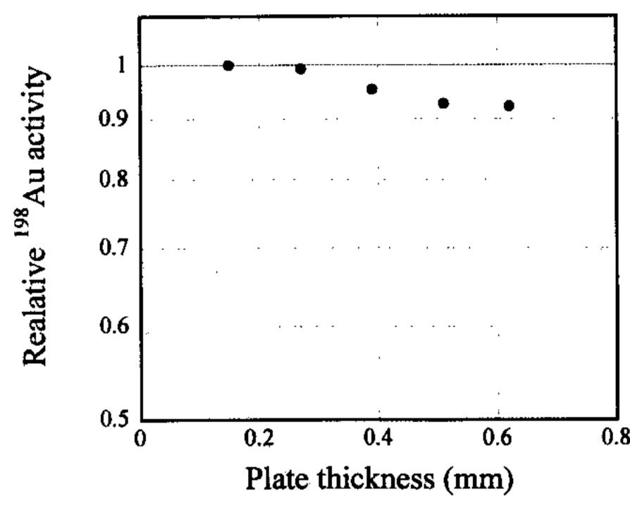
図 2 金板を原子炉外生体遮蔽外壁で中性子 放射化した場合の、金板の厚さに対す る <sup>198</sup>Au 相対放射能
