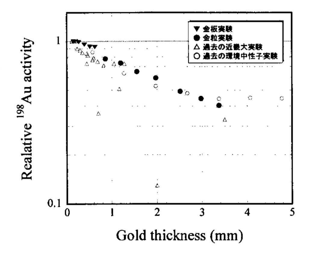
図 3 金の厚さ(粒径)に対する <sup>198</sup>Au 相対放射能 の今回の実験および過去の実験で得た全デ ータ
