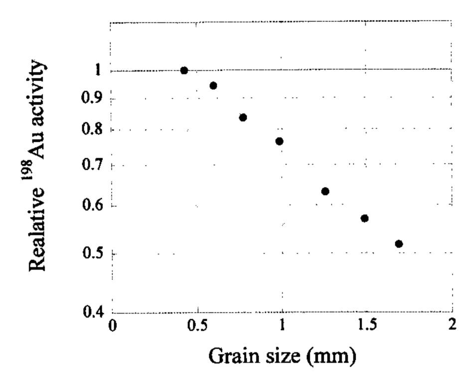
図 1 金粒を原子炉内で中性子放射化した場 合の、粒径に対する <sup>198</sup>Au 相対放射能
