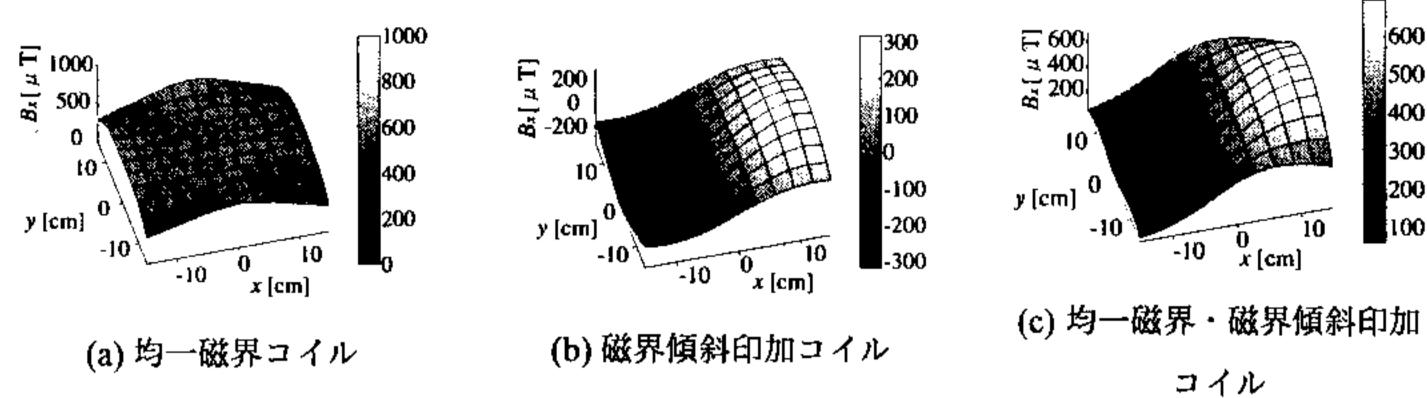
図 4 コイルによる x 方向磁東密度分布 (z=0 cm)
