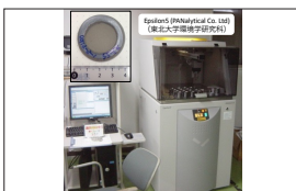
分析に用いたXRF測定装置とベレット試料（左上）
